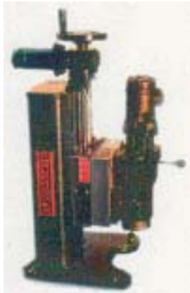
ドリリング加工 ボーリング加工 植込ボルトの現場切削除去技術
