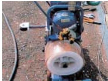
ならいローラーの交換。基準のならいローラーを、外回り用のローラーに前後共交換する。
